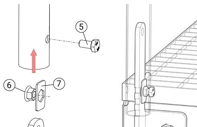
**4. Montage der Geländersicherung**
