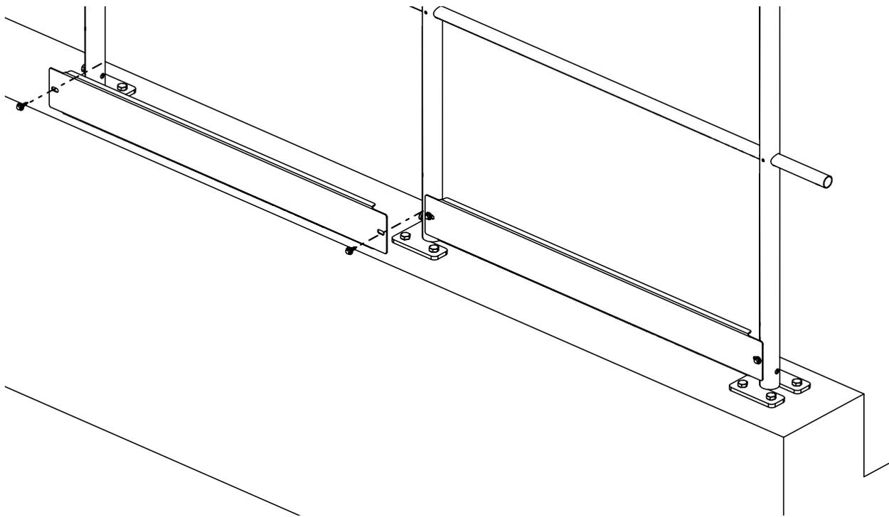
1. Trittleiste mit 2 selbstschneidenden Schrauben montieren.
