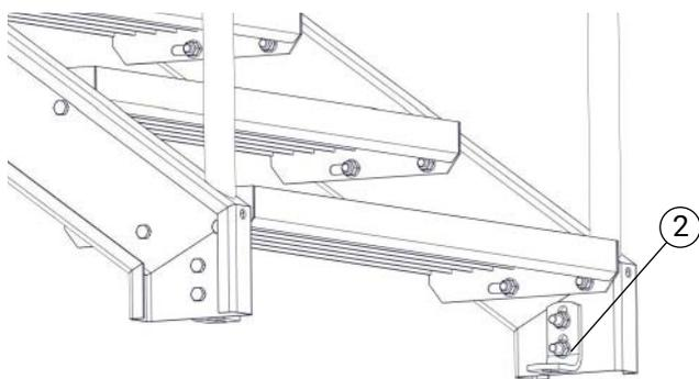
2 x Schraube M12x40 und Flanschmutter für Befestigungswinkel (2) (VF1001).
