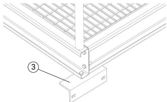
Schraube M12x40 und Flanschmutter Winkel Podestbefestigung (3) (LU8024).
